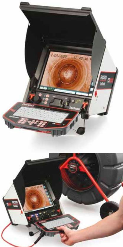
Блок управления видеокамерой CS1000 это специализированный монитор, который позволяет в цифровом формате производить запись и составлять отчеты по осмотрам на месте выполнения работы. CS1000 предоставляет широкие эксплуатационные возможности, необходимые для того, чтобы в полной мере воспользоваться преимуществами технологии цифровой записи.
