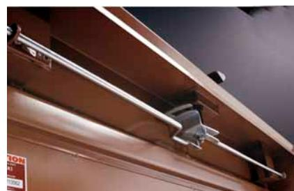
Уникальное нелинейное замковое устройство с тремя защёлками и углублённой ручкой. Ручка приводит в движение крюк-зашелку, а две другие защёлки работают как дверные засовы.
