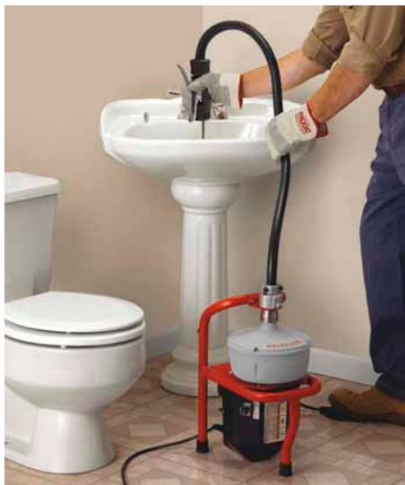
**В раковине:** нажимаете рычаг и спираль подается в сток. Сочетание уникального направляющего шланга и устройства автоподачи AUTOFEED® ставит вас непосредственно над проблемой.
