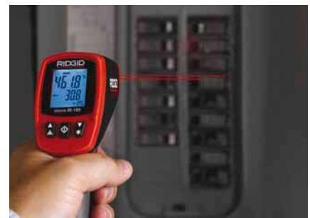
Проверка предохранителя или автоматического прерывателя на предмет перегрева, который может вызывать перегруженные электрические цепи
